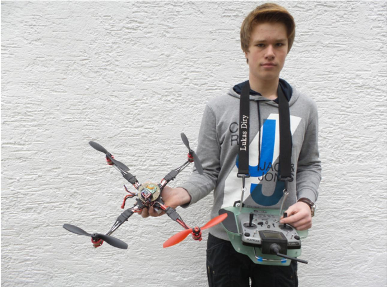
Dieser mit einem Bausatz für wenig Geld zusammengefügte Quadrocopter hat eine Reichweite von 2,5 km. Er wird durch Funk gesteuert, während seine Videokamera die Bilder in die häusliche Wohnstube bringt. (Foto: HB-VeKo)
