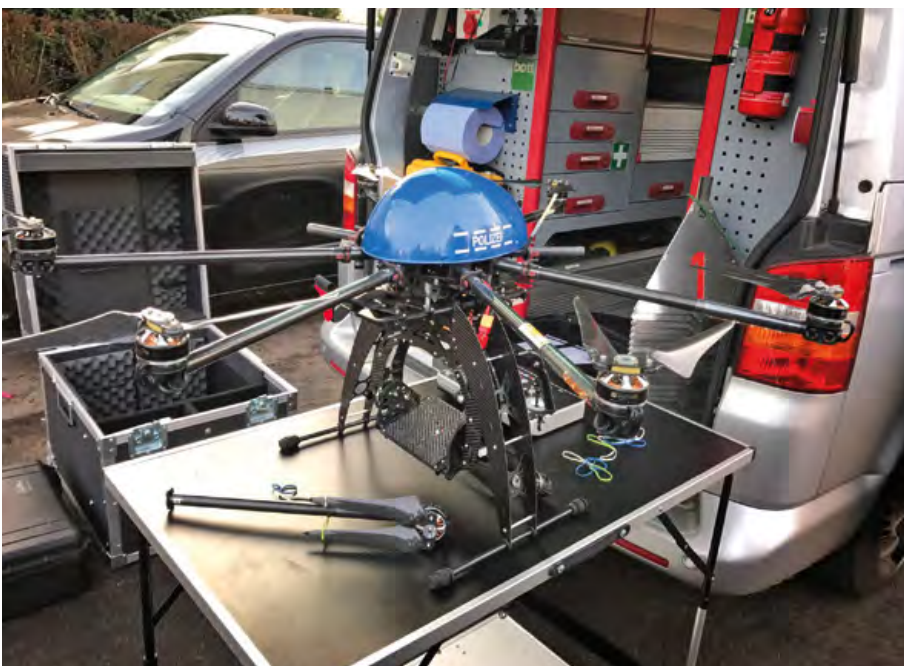
Bei der Berliner Polizei wird die Drohne „Surveying Robot“ des Herstellers Multirotor Service Drone unter anderem für Luftaufnahmen zur Dokumentation von Verkehrsunfällen verwendet. Der Multirotor wird dabei in einem eigenen Technikfahrzeug zum Einsatzort gebracht.
