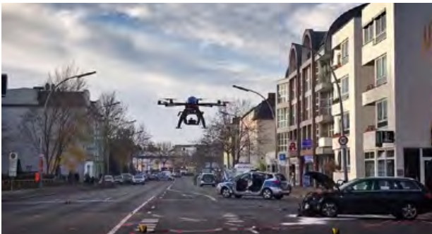
Bei der Berliner Polizei wird die Drohne „Surveying Robot“ des Herstellers Multirotor Service Drone unter anderem für Luftaufnahmen zur Dokumentation von Verkehrsunfällen verwendet. Der Multirotor wird dabei in einem eigenen Technikfahrzeug zum Einsatzort gebracht.
